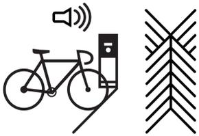
Fahrrad auf die Induktionsschleife am Eingang zur Fahrradstation schieben bis Pfeifton erklingt.
